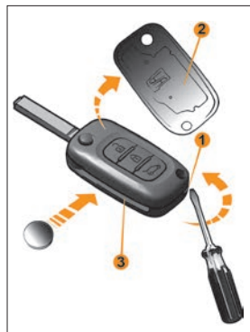
Рис. 9. Замена элемента питания пульта дистанционного управления
