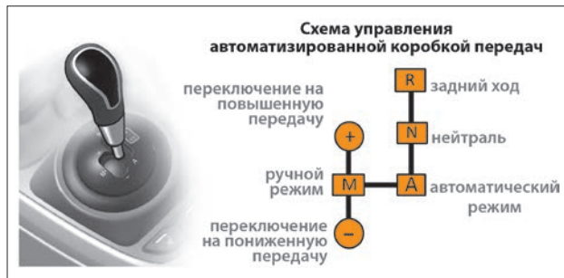
Рис. 3. Рычаг и схема переключения передач
