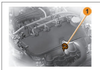
Рис. 1. Проверка уровня масла в картере двигателя
