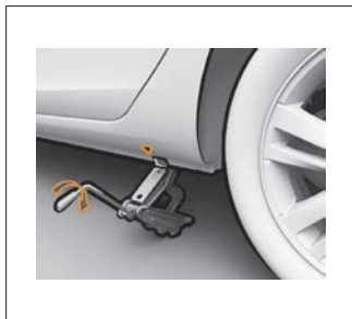
Рис. 3. Положение домкрата при замене колеса
