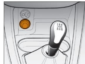
Рис. 2. Розетка для подключения дополнительного электрооборудования
